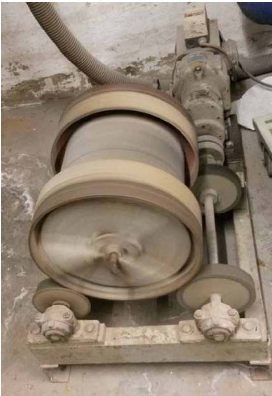
Abbildung 21 eingesetzte Kugelmühle während des Versuches (Quelle ECG)
