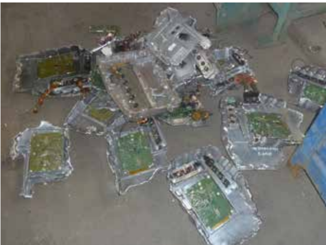
Abbildung 16 Gehäusebestandteile ohne vollständigen Aufschluss – Wiederaufgabe (Quelle ECG)
