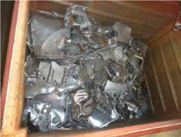
Abbildung 11 Fraktion Aluminium mit Anhaftungen (Quelle ECG)
