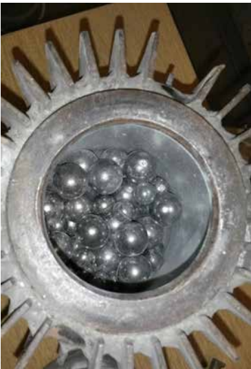
Abbildung 24 „Planet“ – Mahraum mit Mahlkörperfüllung (Quelle ECG)
