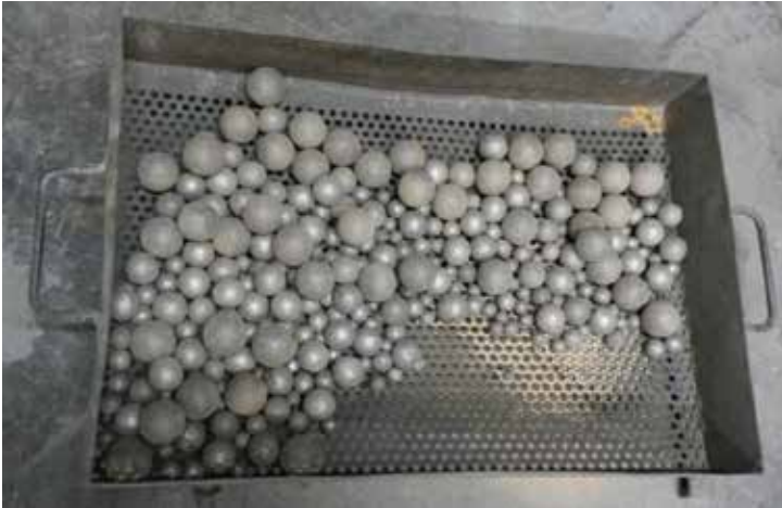
Abbildung 20 eingesetzte Mahlkörper – Kugeln verschiedener Durchmesser (Quelle ECG)
