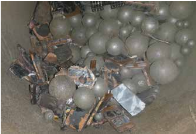
Abbildung 22 Hochleistungsplatinen in der Kugelmühle nach t_3 (Quelle ECG)
